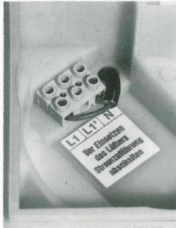
**2.** Netzanschluß an Elektroanschlußteil überprüfen bzw. herstellen.
