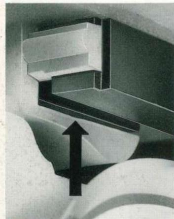
**5.** Abdeckplatte in den Längsschlitz am Klappenträger (Bild oben) stecken und eindrücken, bis beide Rasternasen sowie das Auge einklinken.
