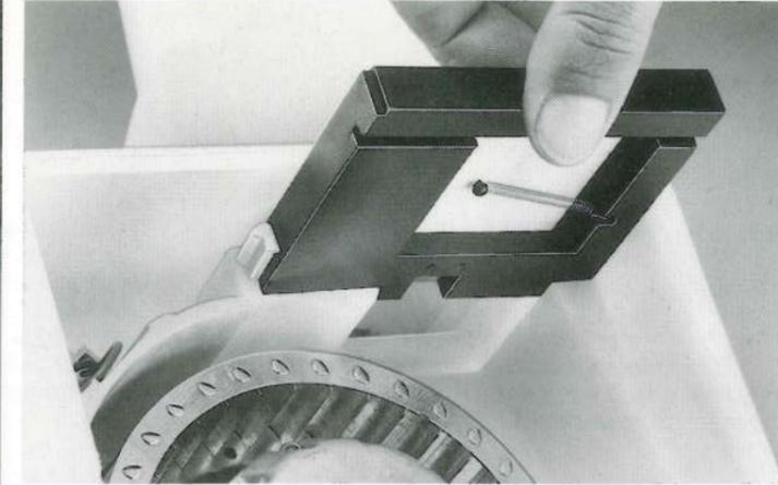
**4.** Klappenträger unterhalb des Ausblasstutzens so einstecken, daß der Dichtgummi in Richtung Ausblasstutzen zeigt (siehe Bild). Es ist darauf zu achten, daß die Klappe in ihrem Bett liegt und nicht über den Rand des Klappenträgers vorsteht. Der Klappenträger muß so fest eingedrückt werden, bis die Kunststoffnase an der linken Seite einrastet.
