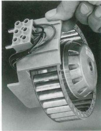
**3.** Lüfterteil am Lüfterträger mit Daumen und Zeigefinger, wie auf Bild (oben) gezeigt, anfassen und gemäß Bild (rechts) einsetzen. Hierbei rastet der Stecker automatisch in das Elektroanschlußteil ein.
