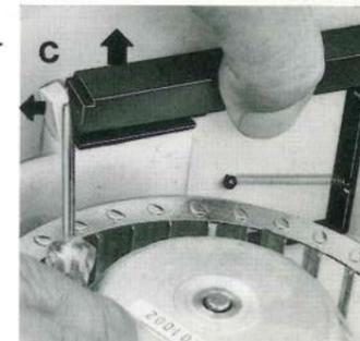
**C.** Die Rückschlagklappe an der Rasternase ebenfalls mit Hilfe eines Schraubendrehers entriegeln (siehe Bild) und herausziehen.
