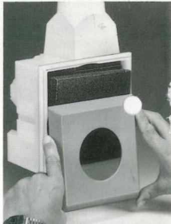
**8.** Den Ansaugdeckel diagonal gedreht so aufsetzen, daß die Klemmfedern innerhalb des Gehäuses sind, dann Ansaugdeckel bis zur waagrecht Lage eindrehen. (Bei zu tief eingeputztem Gehäuse müssen die langen Federn verwendet werden.)
